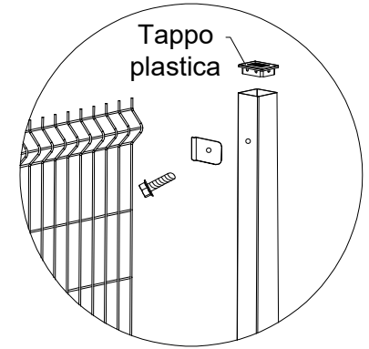
DETTAGLIO ASSEMBLAGGIO PANNELLO
